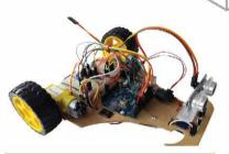
Autorobot que no se colisiona. Relacionarás las propiedades del sonido, del tiempo y de la distancia mediante la programación de un sensor de ultrasonido con Ardublock
