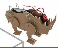
Imita el movimiento de un cuadrúpedo. Aprenderás a combinar el principio de eje excéntrico y manivela para generar el movimiento característico de un cuadrúpedo
