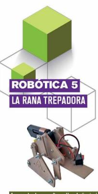
Avanza dando pequeños saltos. Analizarás el concepto de rotación y manivela como una forma de transmisión de movimiento basado en la proporción geométrica y la simetría de un triángulo
