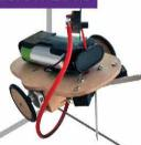
Cambia de dirección al chocar. Aplicarás el principio de energía diferencial y harás que tu robot cambie de trayectoria
