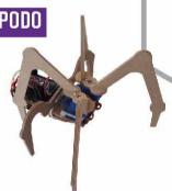
Camina como araña con seis extremidades. Utilizarás software de programación gráfica para robots mBlock basado en *Scratch* para lograr que tu robot camine como una araña
